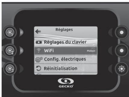
Pour que le menu WiFi s'affiche dans le menu Réglages votre module in.touch doit avoir une version de micro logiciel 11.00 et plus. Ce menu vous permet de connecter votre module in.touch à un réseau sans-fil ou de changer votre module in.touch de réseau.
