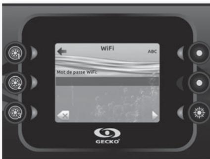
Une fois dans le menu WiFi après quelques secondes les différents réseaux visibles par le module in.touch s'afficheront dans la fenêtre avec la force de chaque signal.
